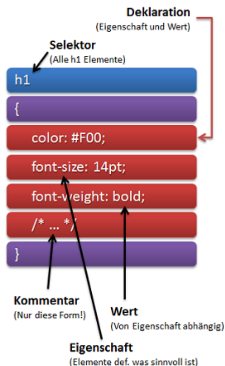
Schema beim Aufbau von CSS-Regeln
