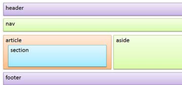
Schemenhafter Aufbau einer Webseite mit den neuen Elementen
